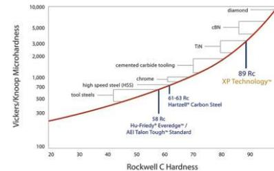
La tecnología **XP** es un proceso de ingeniería de superficies patentado, que produce instrumentos con una superficie mucho más dura que los anteriores.
