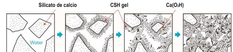
Por absorción de la humedad de los tejidos circundantes en el conducto radicular el silicato de calcio produce gel de CAH (hidrato de aluminato de calcio) y gel CSH (hidrato de silicato de calcio), y se produce una cristalización de Hidróxido de calcio Ca(OH)
